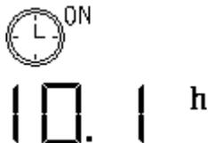
1) Если возле пиктограммы часов отображается ON – активен режим установки времени включения нагревателя, если OFF – режим установки времени выключения. Переключения между этими двумя режимами осуществляется коротким нажатием кнопки настроек (4).
